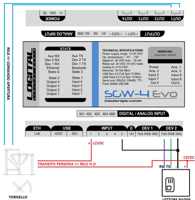
SGW4-EVO è un controllore programmabile dotato di I/O digitali e di una serie completa di porte di comunicazione che consente in modo semplice, veloce ed affidabile l'interfacciamento e la gestione centralizzata su reti dati di dispositivi periferici remoti.
