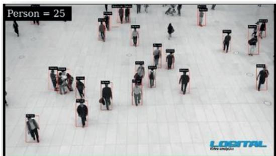
Conteggio in tempo reale di persone, sia su punti di attraversamento per un monitoraggio dei flussi in ingresso-uscita da varchi, sia in aree definite per eseguire analisi di code o controllo anti-assembramento. Controllo della presenza in zone proibite.
